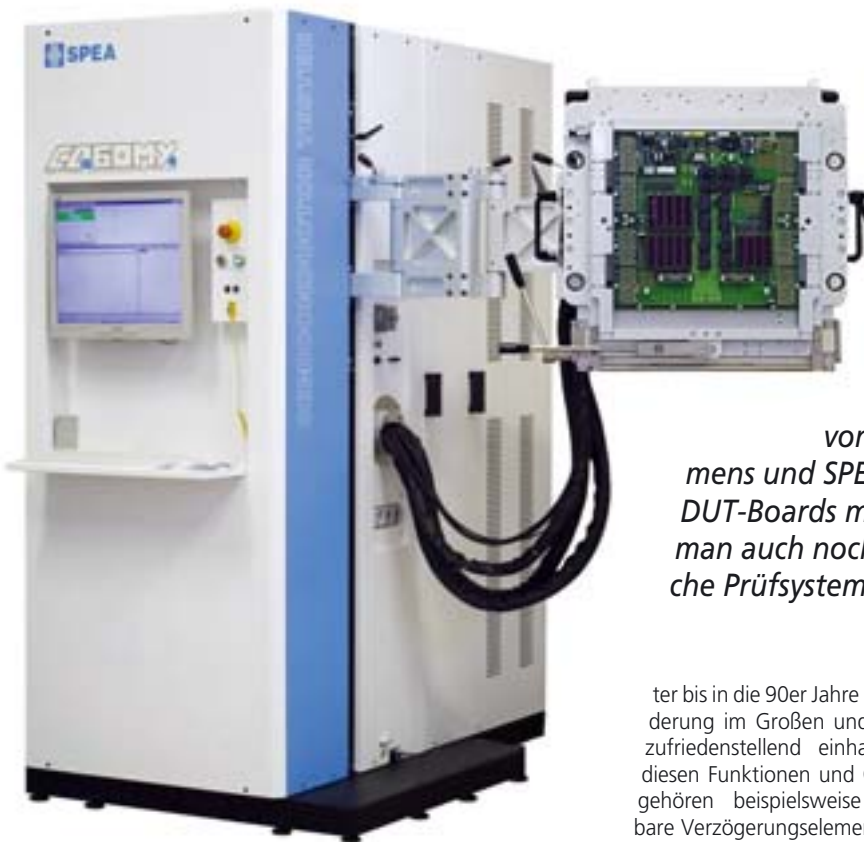
Bild 1: Testsystem für Mixed Signal- und Leistungsbauteile, im Testhead befinden sich 16 universell belegbare Kartenslots, in der Mainframe die Instrumente und Leistungsmodule (SPEA)
